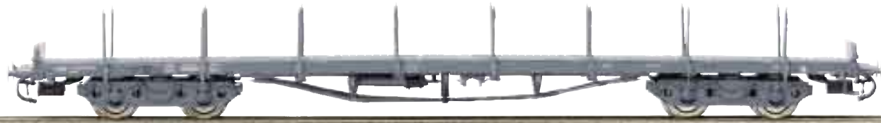
3303 Carro pianale tipo Rs 344 delle NS, nuova numerazione. Rs 344 flat car of the NS, new service numbers.
