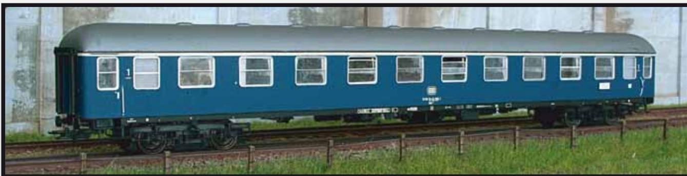
**Aüm202 DB-Reisezugwagen für F- und TEE-Züge** (mit Magnetschienen-Bremse für max. 160 km/h)
