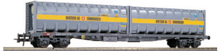
71 008 ~ AC / 71 009 = DC SBB Flachwagen für Container Typ Sgs, mit 2x30 ft. Bulkcontainer von Bertschi
