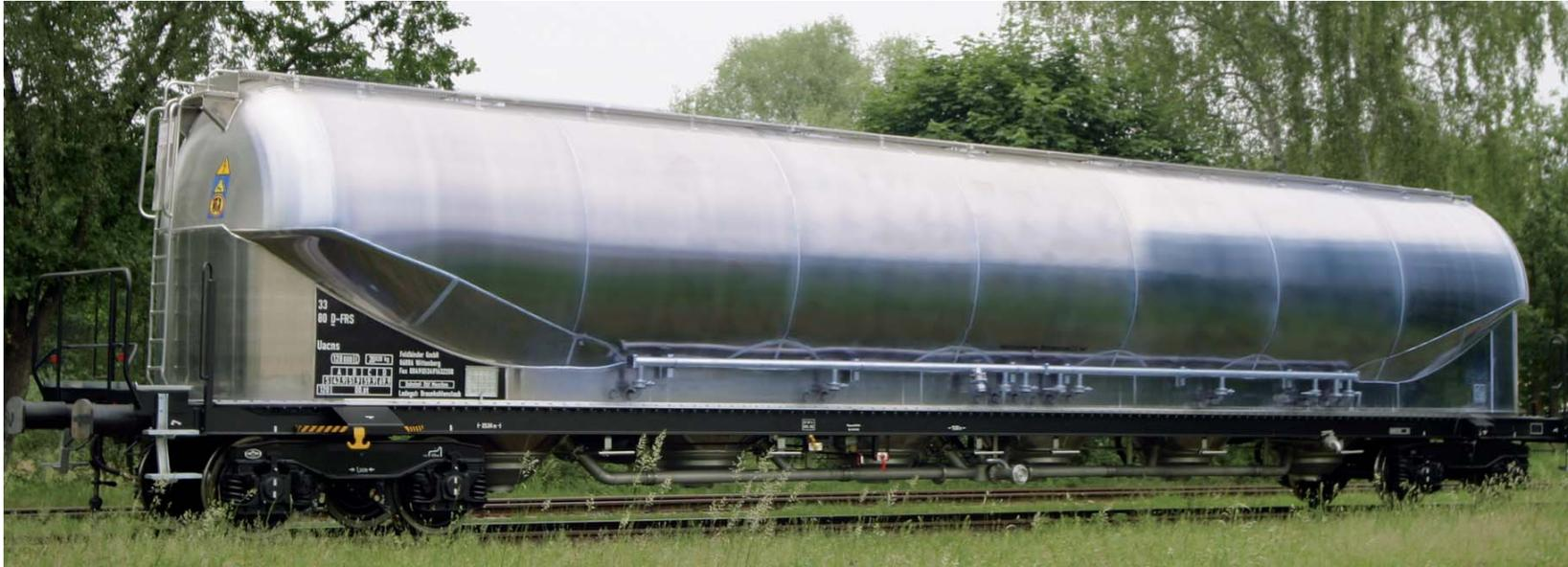
Für den Transport von Braunkohlenstaub wurden bei der Firma FELDBINDER 145 vierachsige Silowagen vom Typ Uacns bestellt. Bei einem Fassungsvermögen von 128 m<sup>3</sup> können diese Wagen bis zu 69,7 t Staub aufnehmen. Die Wagen sind mit den neu konstruierten Drehgestellen vom Typ Y25 Lsif-C ausgestattet. Unter anderem wurden die Wagen an die Firmen ERMEWA, RSB Logistics und VATTENFALL geliefert.
