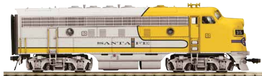
Dieselektrische Lokomotive F7 der Atchison Topeka & Santa Fe. A-Unit mit Führerstand. Serie 300. Bauart B-B. Epoche IV
