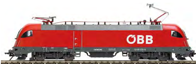
120 05652 2 Elektrolokomotive Rh 1116 der Österreichischen Bundesbahnen; Ausführung ES 64 U2 »Taurus« als Mehrzwecklokomotive
