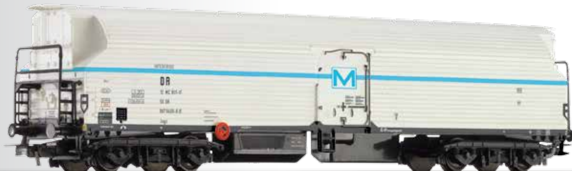
Maschinenkühlwagen der INTERFRIGO, eingestellt bei der DR Mechanical refrigerator waggon of the INTERFRIGO
