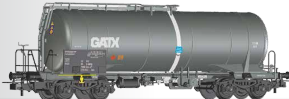
Kesselwagen Zaes der GATX, mit Heizeinrichtung Tank car Zaes of the GATX with heating amatures
