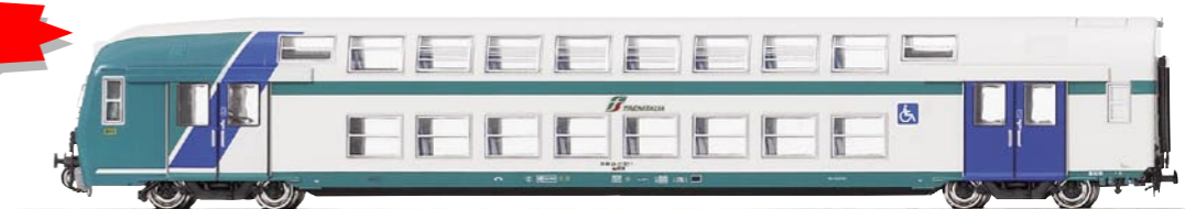
3099 Carrozza pilota due piani di seconda classe con nuovo logo Trenitalia. Pilot coach 2nd class double deck coach with new logo Trenitalia.
