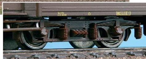
*Dettaglio del nuovo carrello FS Tipo ABM con boccole a rulli (muso di porco) montato sulle vetture di prima classe e Ristorante-Bar.*
