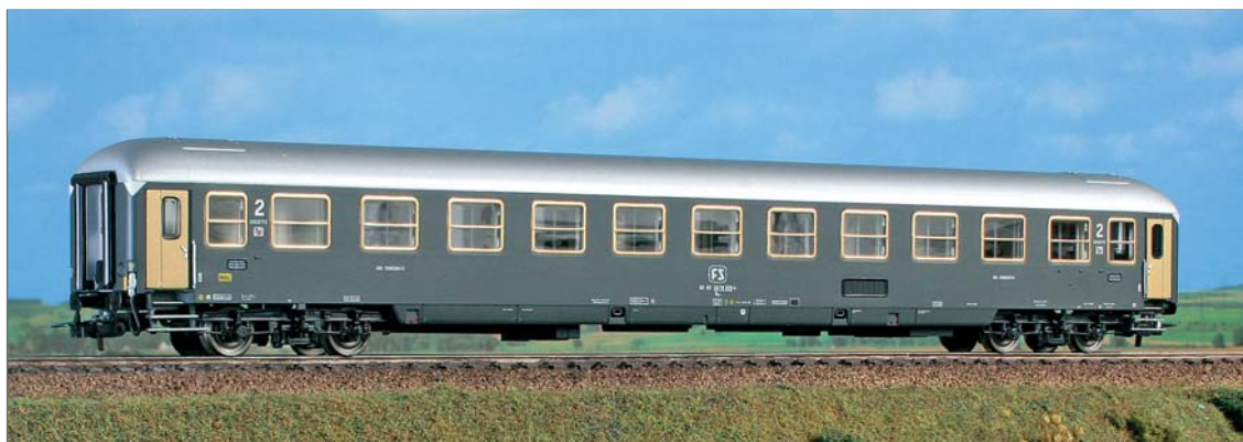
Carrozza di 2° classe a cuccette Tipo X 1970, nella livrea grigio ardesia, carrelli MD. Epoca IV/V 2 nd class couchette car Type X 1970, slate gray livery, Type MD bogies. Epoque IV/V
