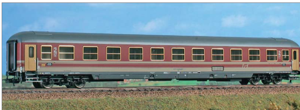
Carrozza di 2° classe a cuccette Tipo X 1970, nella livrea beige e rosso fegato, carrelli MD. Epoca IV/V 2 nd class couchette car Type X 1970, beige and deep red livery, Type MD bogies. Epoque IV/V
