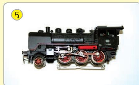
Zum Abschluss das Gehäuse wieder auf die Lok aufbringen und darauf achten, dass keine Leitungen eingeklemmt werden.
