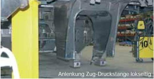
Anlenkung Zug-Druckstange lokseitig
