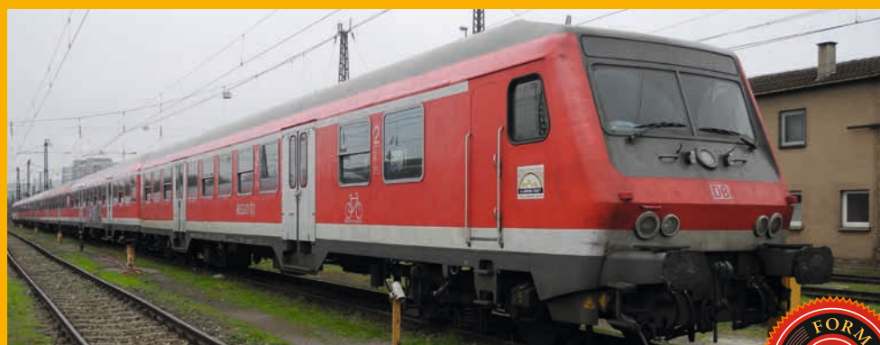
Steuerwagen Bnrdfz 483.1 der DB AG Betriebs-Nr. 50 80 80-35 191-1
