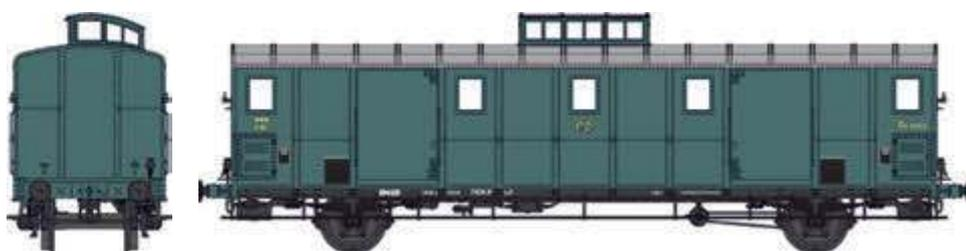
**VB-108** - FOURGON OCEM 29 PO, toit riveté, Vigie PO, boîtes à coussinets, PO Grilles aux fenêtres - Ep. II
