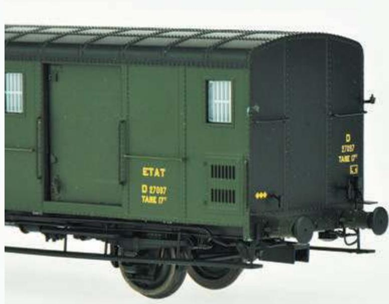
**VB-113** - FOURGON OCEM 30 Toit riveté et bouts noirs, 2 petits feux et 1 droit, boîtes à coussinets, «SOTTEVILLE» Ex-ETAT Barres aux fenêtres N°39824 feux de fin de convoi - Ep.III
