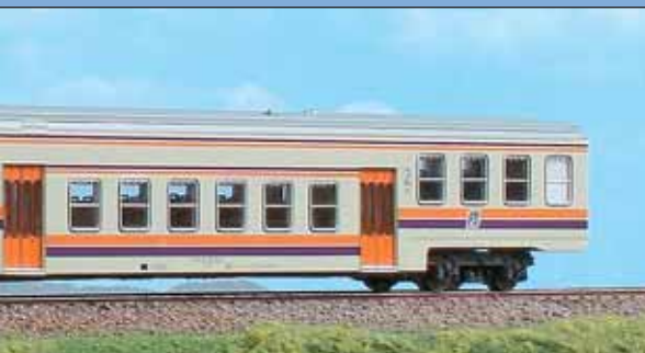
Carrozza FS Tipo 1957R (Corbellini lunga o Corbellona) in livrea grigio ardesia con marcatura unificata e carrelli FS 27. FS car Type 1957R in slate gray livery for local service. FS-Wagen Typ 1957R (langer Corbellini) in schiefergrauer-Lackierung.
