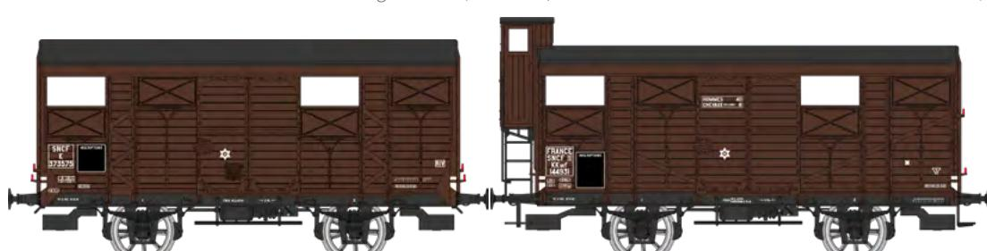
**WB-701 Coffret de 2 couverts PLM 20 t - brun wagon 540, K 373575 avec renforts de caisse en Z, et Kf391789 avec guérite, SNCF Ep.III B**
