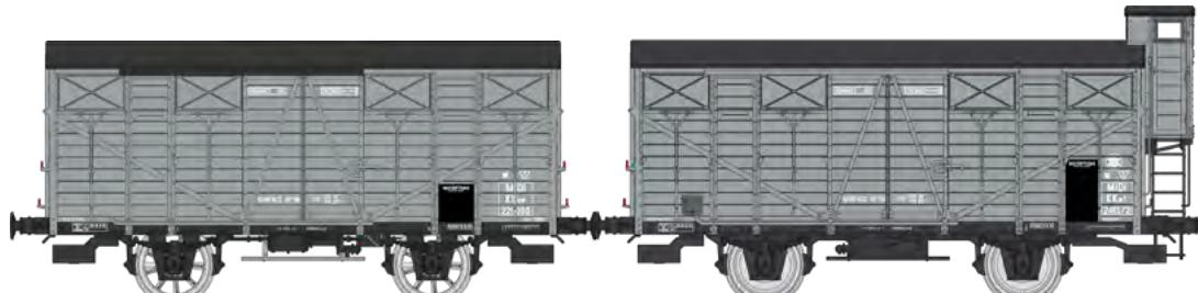
**WB-683 Coffret de 2 couverts OCEM 19** KKuw 229005, roues à rayons, volets fermés et KKwf 241572, roues pleines, volets fermés et guérite, MIDI Ep.II.
